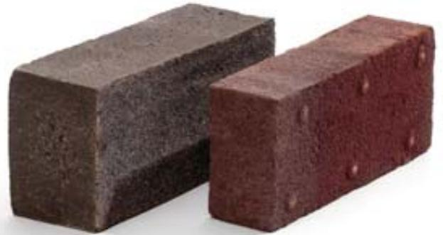
Die Textur besandeter Pflasterklinker unterscheidet sich von der Textur der Wasserstrich-Pflasterklinker mit unbesandeter Oberfläche. Die Wahl orientiert sich am gewünschten Erscheinungsbild einer Straße oder an den Anforderungen an Design der Ziegel. Worin liegen die Unterschiede?
